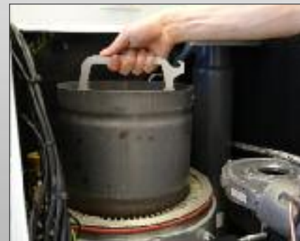
Brennkammer und Verdränger mit Wartungswerkzeug herausziehen
