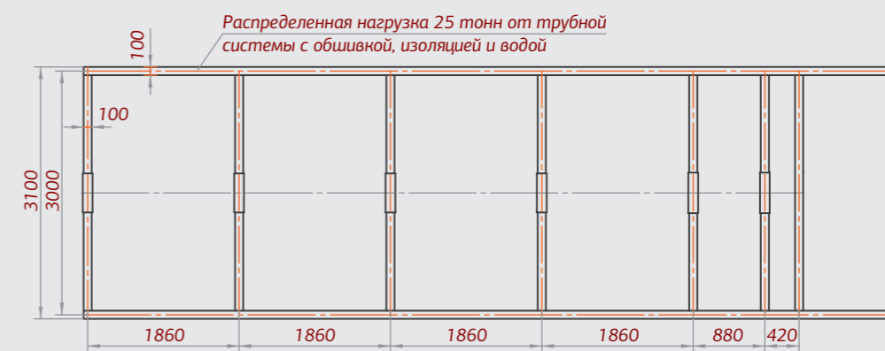
Нагрузки на фундамент от котла
