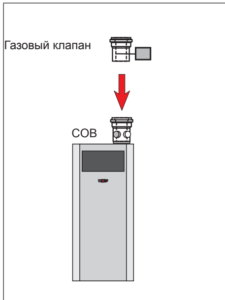
Монтаж газового клапана
