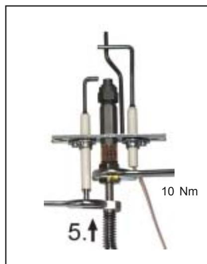
Al termine della trasformazione controllare la tenuta del gas!
