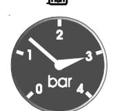
**Манометр** показывает давление воды в системе отопления. При нормальном режиме эксплуатации давление воды в системе отопления должно составлять 1,5-2,5 бар.
