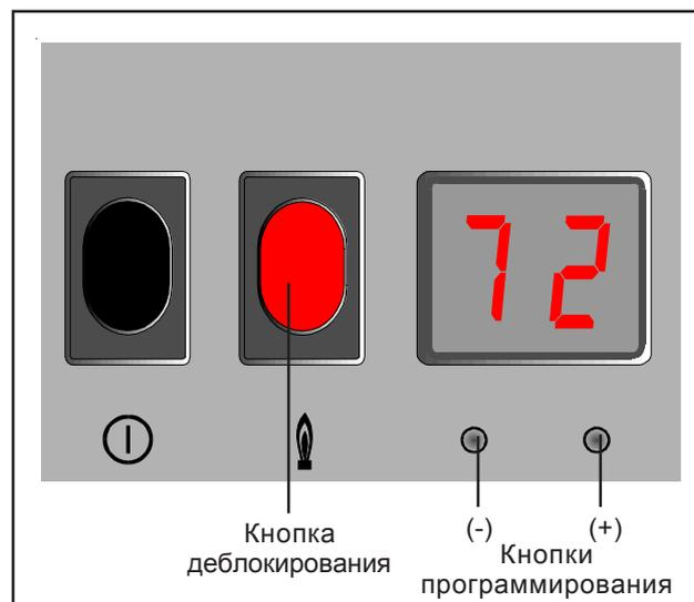
Рис.: Дисплей устройства регулирования
