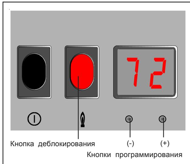
Рис.: Дисплей устройства регулирования
