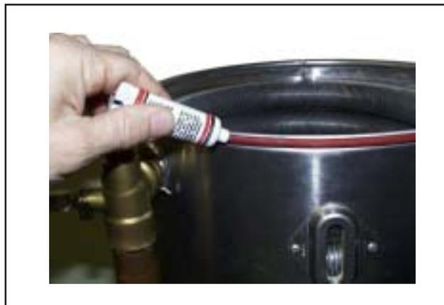
Рис.: Все уплотнения смазать силиконовой смазкой.
