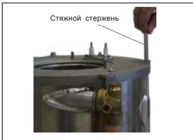
Рис.: Стяжной стержень большой крышки камеры сгорания
