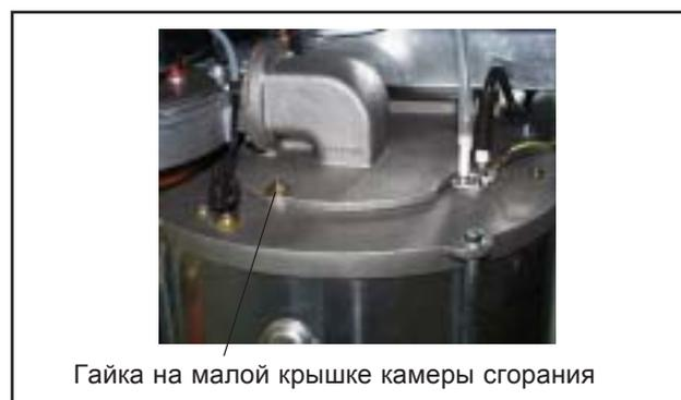
Рис.: Гайка на крышке камеры сгорания
